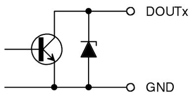
Obr.3. Zjednodušené schema obvodů digitálních výstupů.
