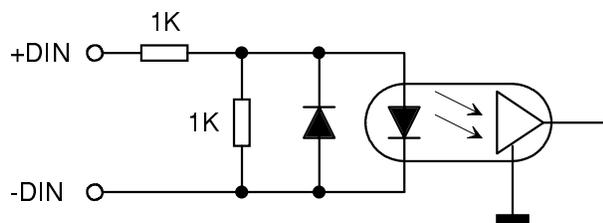
Obr.2. Zjednodušené schema obvodů digitálního vstupu.
