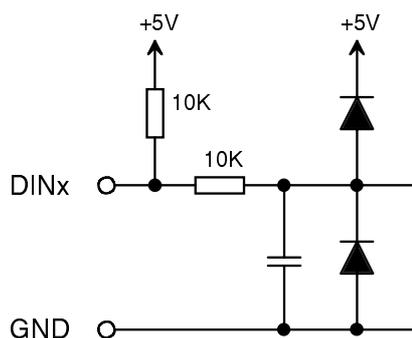
Obr.2. Zjednodušené schema obvodů digitálních vstupů.
