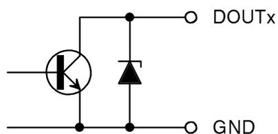
Obr.3. Zjednodušené schema obvodů digitálních výstupů MU-802.
